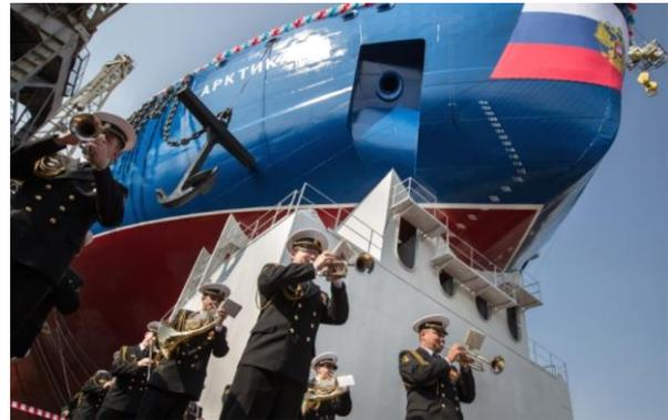
«Арктика» станет самым большим и мощным ледоколом в мире. Его длина – 173,3 метра, ширина – 34 метра, осадка по конструктивной ватерлинии – 10,5 метра, минимальная рабочая осадка – 8,55 метра. Водоизмещение - 33,54 тыс. тонн. Ледокол оснащен усовершенствованной интегральной реакторной установкой «РИТМ 200».
