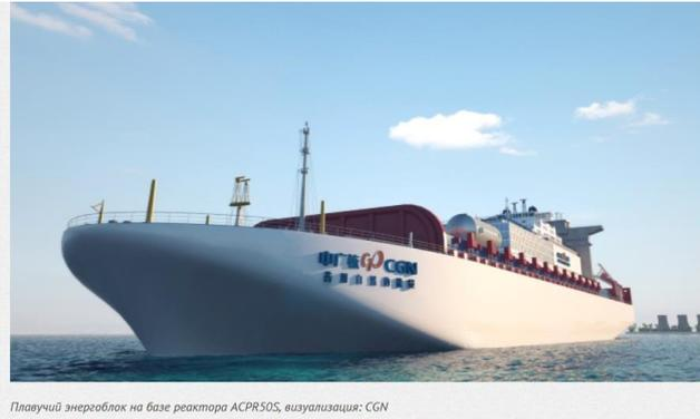
Плавучий энергоблок на базе реактора ACPR50S, визуализация: CGN
