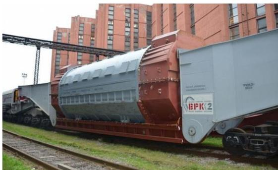
«Силовые машины» произвели отгрузку статора турбогенератора мощностью 1200 МВт, изготовленного для Белорусской атомной станции.
