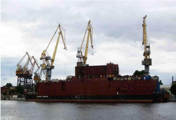
*Строительство ведётся на основании лицензии, выданной Ростехнадзор на право сооружения ЯЭУ ПЭБ с РУ КЛТ-40С. Головной ПЭБ после окончания строительства, испытаний, транспортировки будет размещён и введён в эксплуатацию в составе первой российской плавучей атомной теплоэлектростанции (ПАТЭС) в акватории Морского торгового порта г. Певек Чукотского автономного округа. Тип судна - несамоходное стоечное.*
